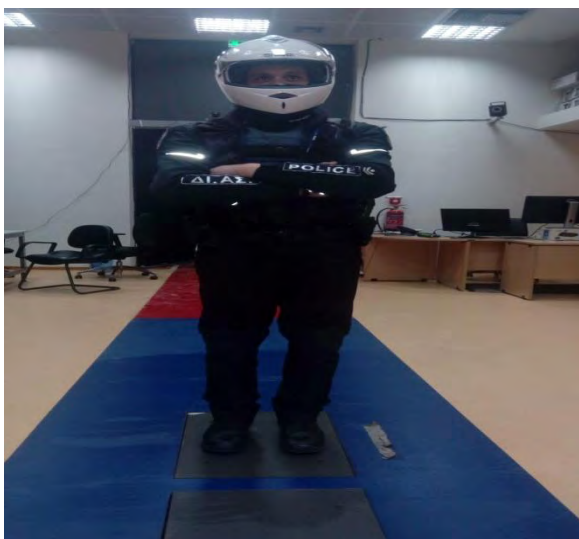
Εικόνα 4.2.2.1 Δοκιμασία ισορροπίας στο δυναμοδάπεδο, με στήριξη στα δύο πόδια και τα μάτια ανοιχτά.
