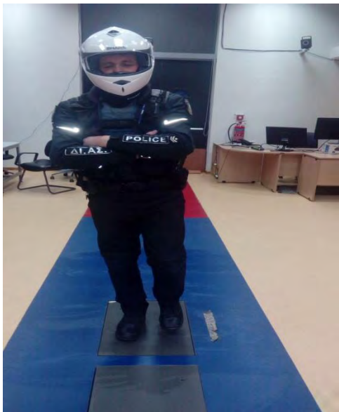
Εικόνα 4.2.2.4 Δοκιμασία ισορροπίας στο δυναμοδάπεδο, με στήριξη στο δεξί πόδι και τα μάτια κλειστά.
