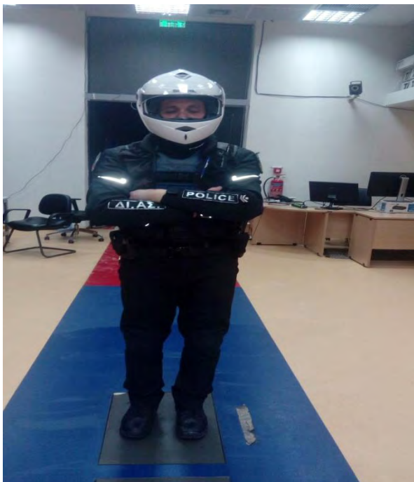
Εικόνα 4.2.2.2 Δοκιμασία ισορροπίας στο δυναμοδάπεδο, με στήριξη στα δύο πόδια και τα μάτια κλειστά.
