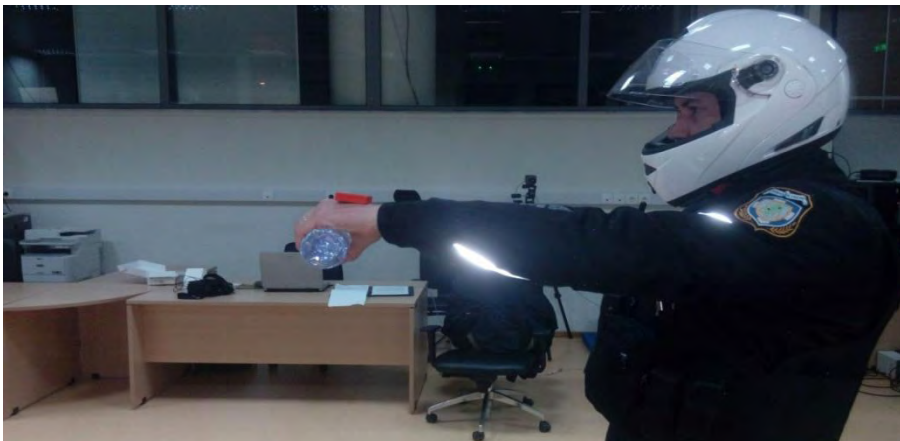
Εικόνα 4.2.2.7 Δοκιμασία ισορροπίας και κινητικότητας αριστερού χεριού-ώμου, με βάρος, χρησιμοποιώντας το επιταχυνσιόμετρο .
