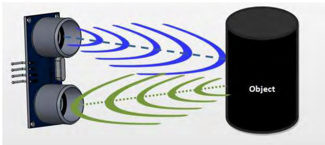
Εικόνα 10 Διάγραμμα της βασικής λειτουργίας αισθητήρα υπερήχων
