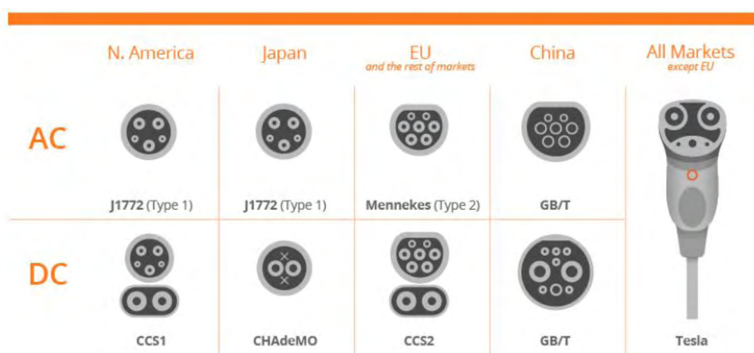
Εικόνα 16. Τύποι υποδοχέων ρευματοληπτών φόρτισης ηλεκτρικών οχημάτων
