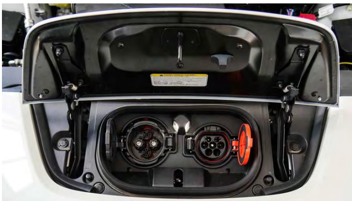
Εικόνα 21. Υποδοχείς φόρτισης Chademo και Type 2 σε Nissan Leaf (2018)
