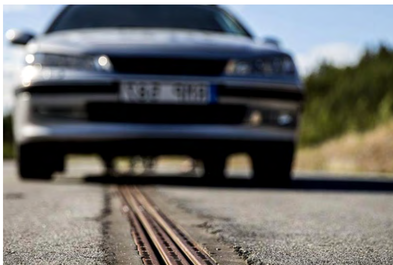
Εικόνα 13. Φόρτιση κατά την κίνηση του οχήματος
