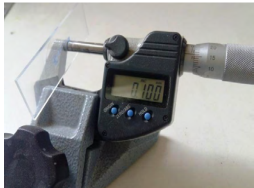
Εικόνα 34. Έλεγχος του τελικού πάχους της ιστολογικής τομής με ηλεκτρονικό παχύμετρο.
