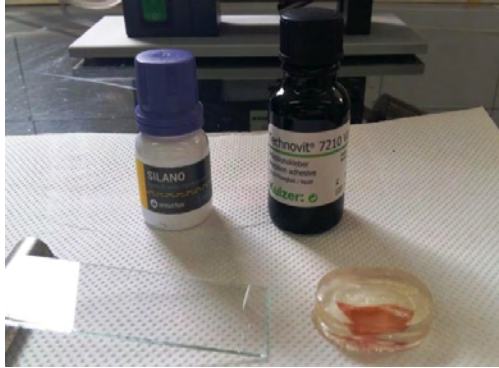
Εικόνα 31. Απαραίτητα υλικά για τη συγκόλληση στο πλακίδιο ιστολογίας (σιλάνιο και ημίρρευστη ρητίνη)
