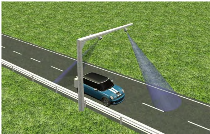
Σχήμα 3- 5: Ανιχνευτής μικροκυμάτων Doppler
