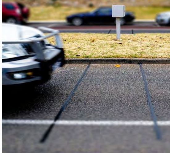
Σχήμα 3- 3: Παράδειγμα πιεζοηλεκτρικού μηχανισμού
