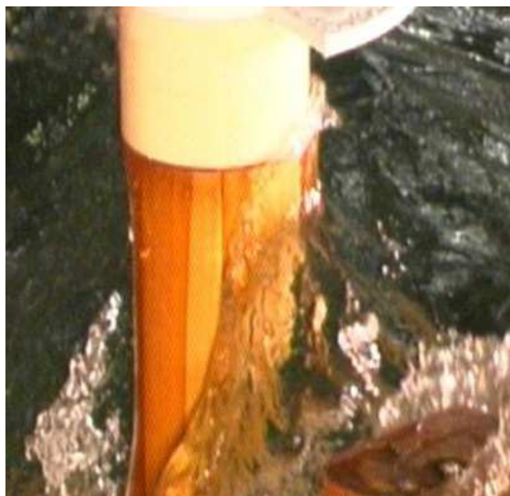
Εικόνα 5.1: Αναρρίχηση κυματισμού σε υποστυλώμα σκυροδέματος - πειραματική προσομοίωση (Wave-Structure Interactions at the Sleipner A GBS, 2012)
