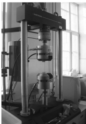
Σχήμα 2.21 Πειράματα κυκλικής φόρτισης του καλώδιου από κράματα μνήμης μορφής
