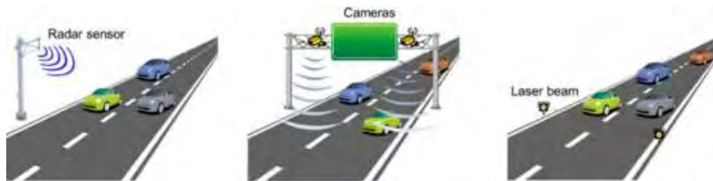
Σχήμα 3.32: Χρήση ραντάρ και αισθητήρων για τον έλεγχο της κυκλοφορίας (Πηγή: mdpi.com)
