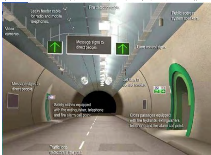
Σχήμα 2.11: Εξοπλισμός Σήραγγας (Πηγή: «ΔΟΕΚ», Πανεπιστήμιο Θεσσαλίας)
