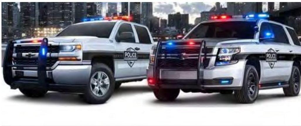
Σχήμα 4.10: Αστυνομικά οχήματα με ειδικά διαμορφωμένο προφυλακτήρα για τη διένεξη οδού (pushbumpers), (Πηγή: streetblogUSA.org)
