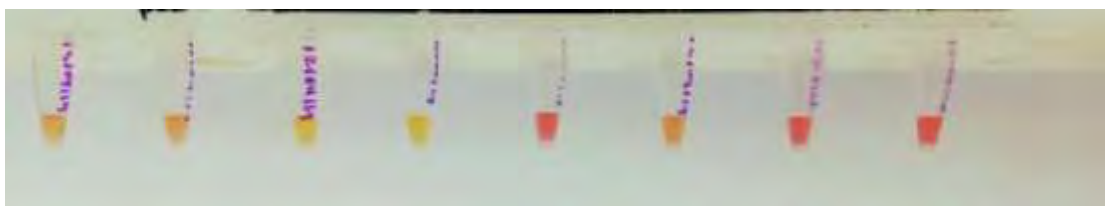
Εικόνα 4.4 .1 Colorimetric LAMP σε κλινικά δείγματα. Τα τρία ροζ δείγματα είναι οι αρνητικοί μάρτυρες
