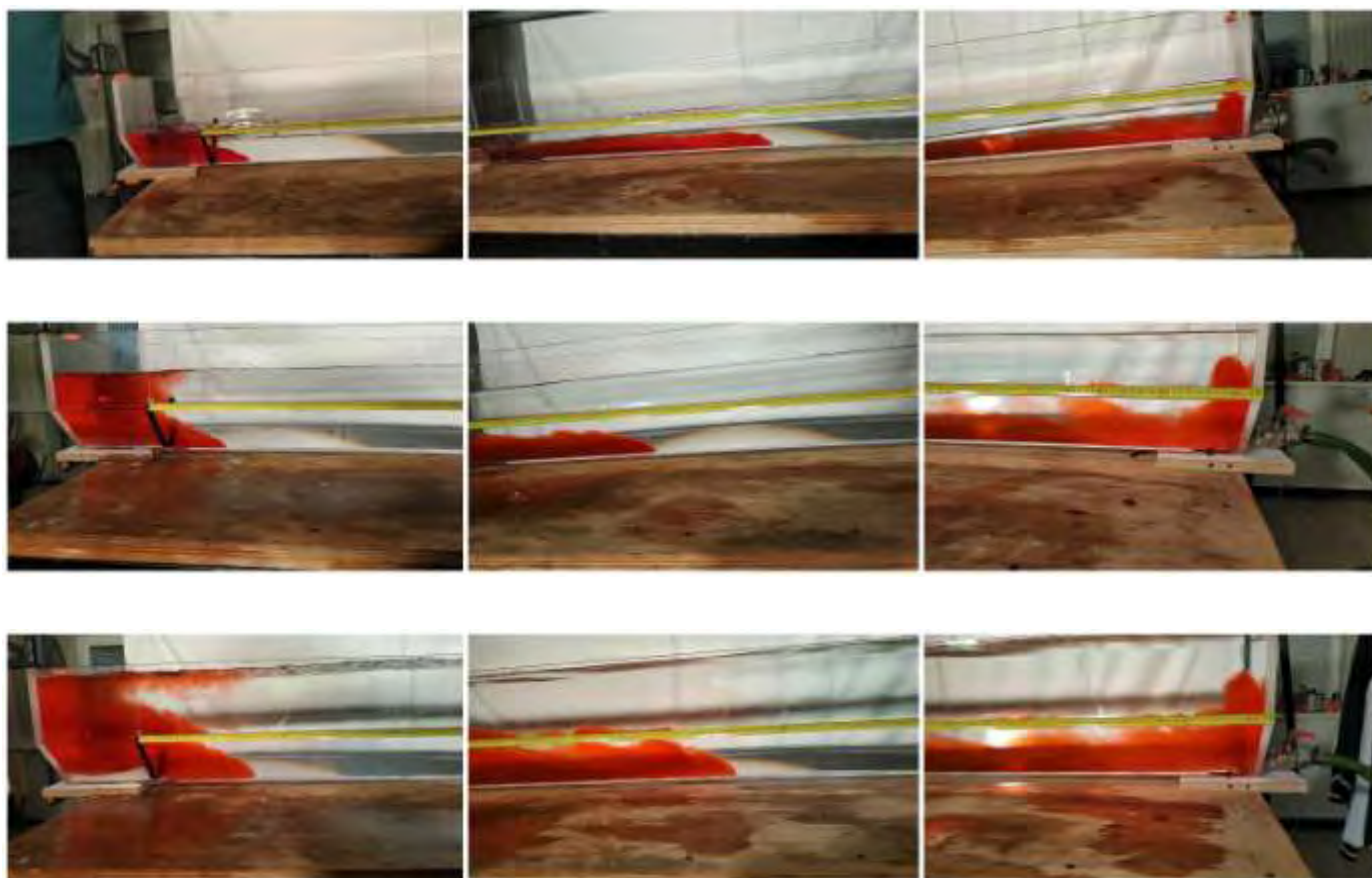
Εικόνα 7.7 Στιγμιότυπα εκτέλεσης πειραμάτων πυκνότητας \rho=1050\text{kg/m}^3 για Ho 5, 10, 17.5 και 25 εκατοστών
