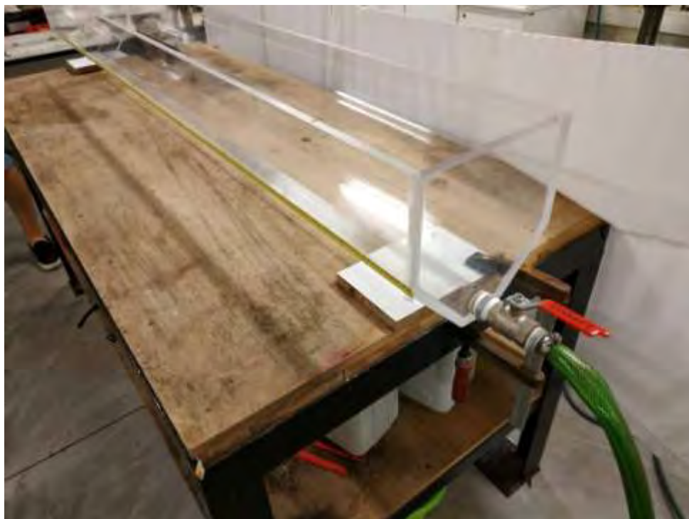
Εικόνα 7.3 Έξοδος γυάλινης δεξαμενής 220 εκ. σε μήκος.
