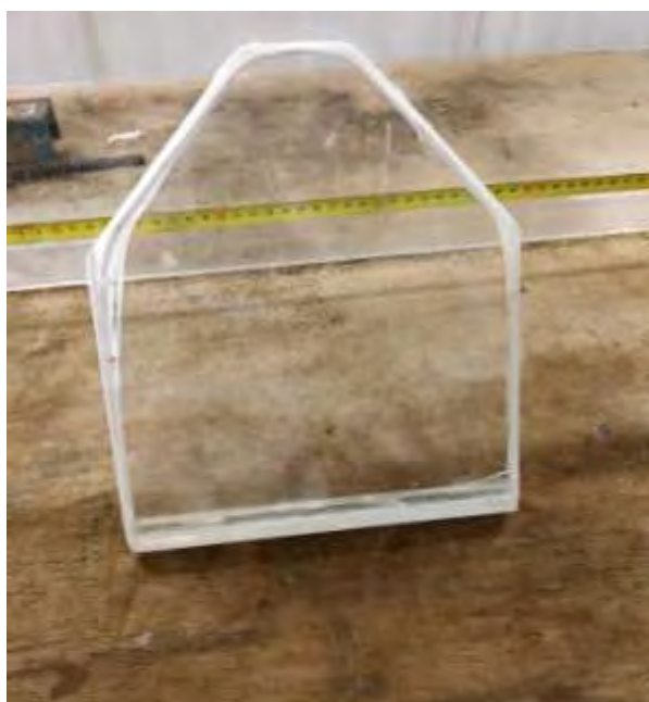
Εικόνα 7.4 Θυρόφραγμα ύψους 25εκ σύνθετης διατομής.
