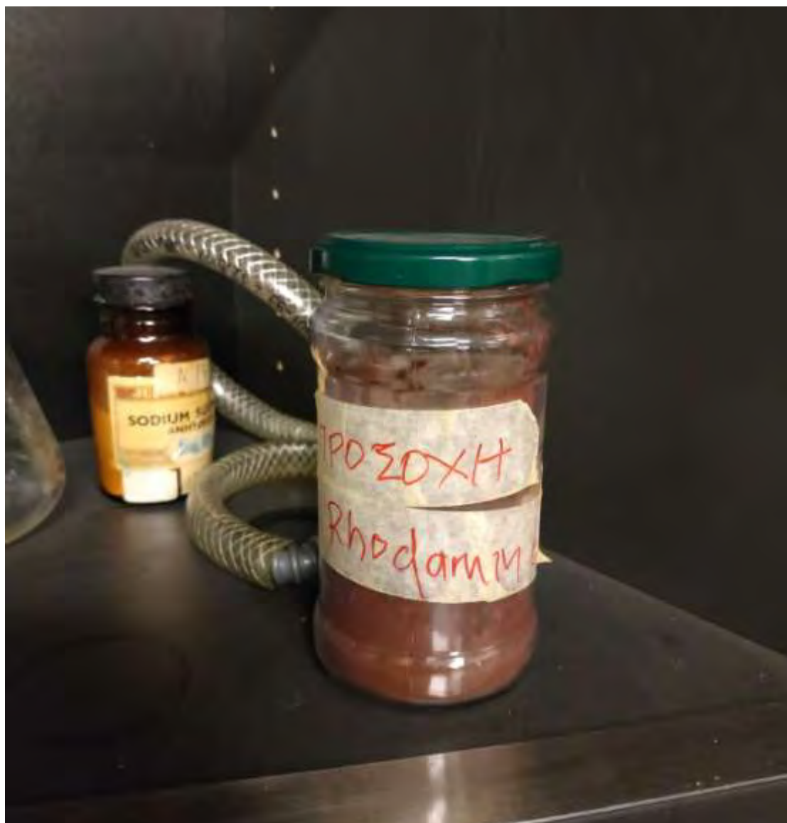
Εικόνα 7.7 Ροδαμίνη, υλικό που προσδίδει χρώμα στα ρεύματα βαρύτητας των πειραμάτων.
