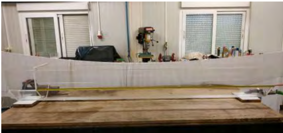
Εικόνα 7.1 Γυάλινη δεξαμενή 220 εκ. σε μήκος, πλάτους 23εκ. στο άνω και 5εκ. στο κατώτερο μέρος.
