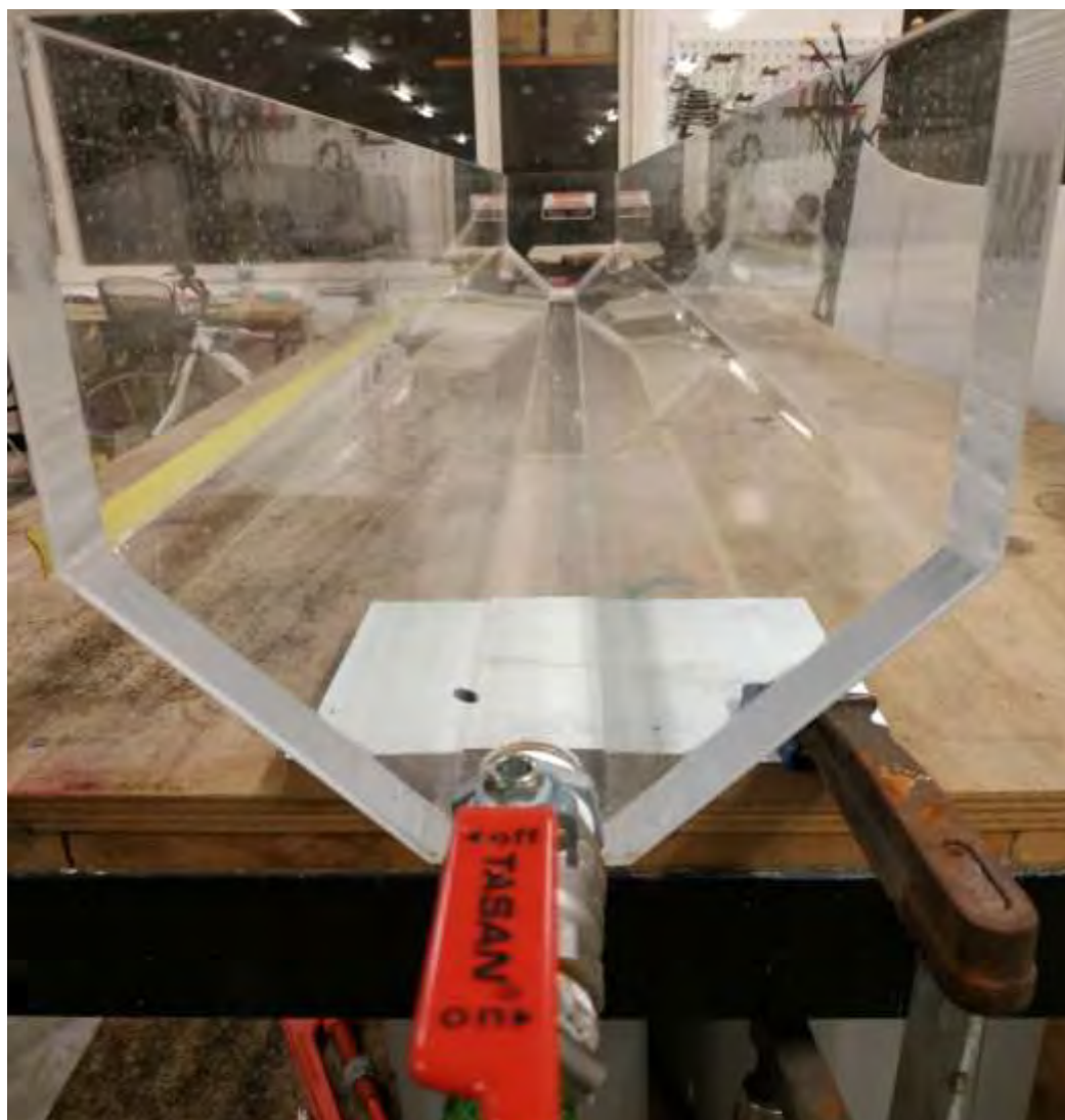
Εικόνα 7.5 Προφίλ εξόδου γυάλινης δεξαμενής 220εκ. σε μήκος.
