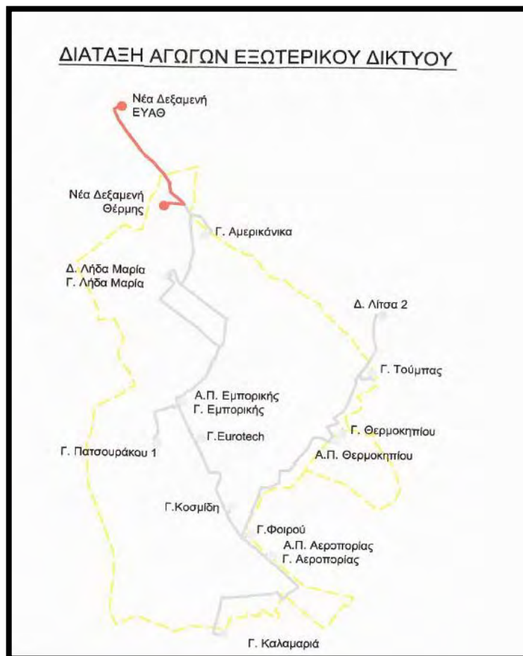
Εικόνα 12: Διάταξη αγωγών εξωτερικού δικτύου Θέρμης
