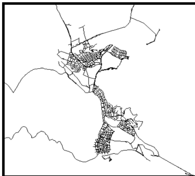
Εικόνα 18: Αποτύπωση δικτύου ύδρευσης Δ.Ε Ηγουμενίτσας σε WaterGEMS
