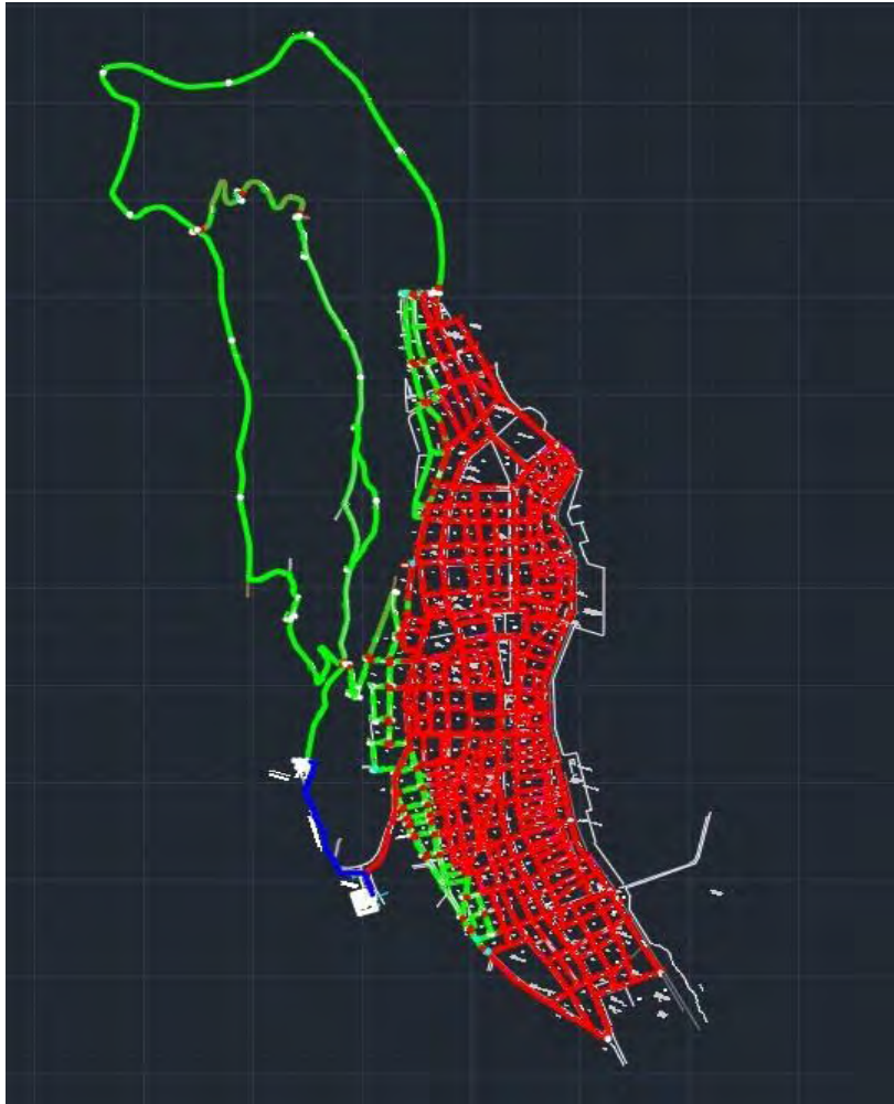
Εικόνα 15: Αποτύπωση δικτύου ύδρευσης Αργοστολίου σε AutoCAD.
