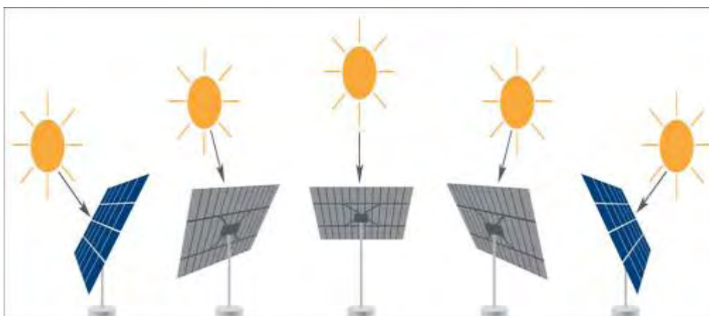
Εικόνα 3.25: Προσανατολισμός των φωτοβολταϊκών πλαισίων ανάλογα με την πορεία του ηλίου.
