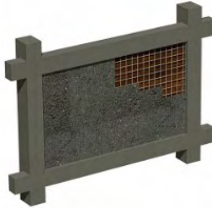
Σχήμα 2.12 – Ενισχυμένη τοιχοπλήρωση (Δρίτσος 2003).
