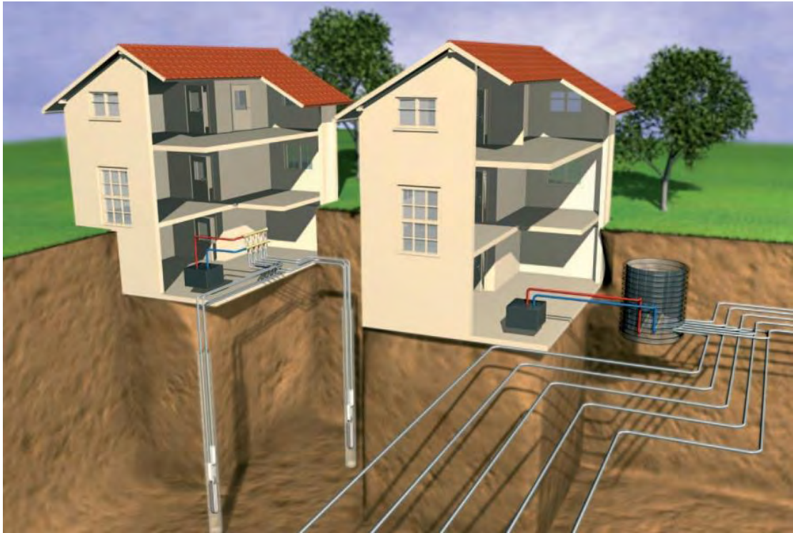
Εικόνα 37. Κατακόρυφα και οριζόντια γεωθερμικά συστήματα
