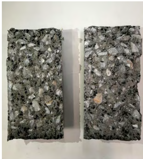
Σχήμα 2.2: Κατανομή των κόκκων καουτσούκ στο σύνολο του κυλινδρικού δοκιμίου
