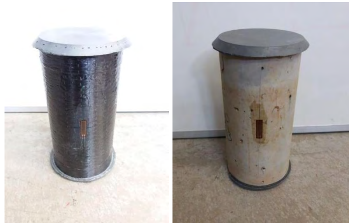
Σχήμα 2.14: Δοκίμια με επιπεδωμένες επιφάνειες φόρτισης
