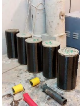
Σχήμα 2.9: Ενίσχυση δοκιμίων με ίνες
