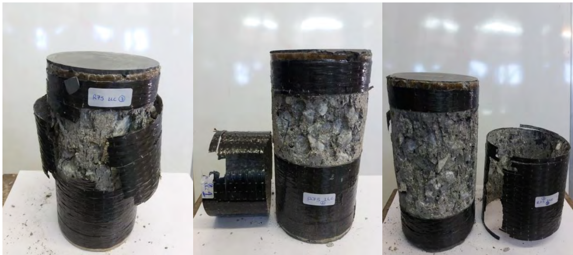
Σχήμα 3.16: Μορφές αστοχίας των κυλίνδρων CR75 μετά τη δοκιμή.
