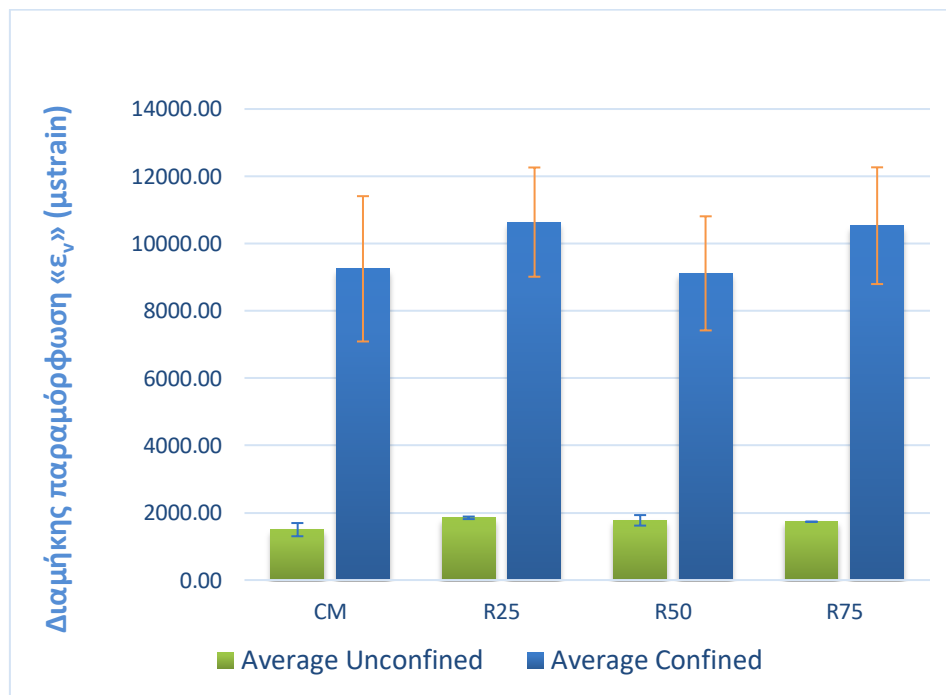
Σχήμα 4.5: Σύγκριση τιμών διαμήκους παραμόρφωσης μεταξύ περισιφιγμένων και μη περισιφιγμένων δοκιμίων
