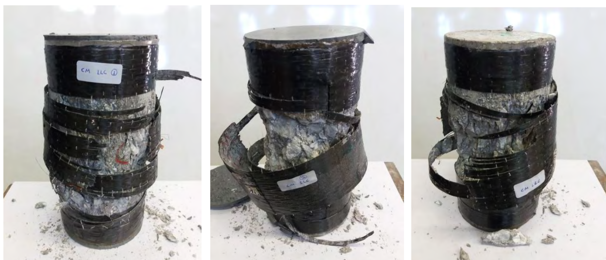
Σχήμα 3.10: Μορφές αστοχίας των κυλίνδρων CCM μετά τη δοκιμή.
