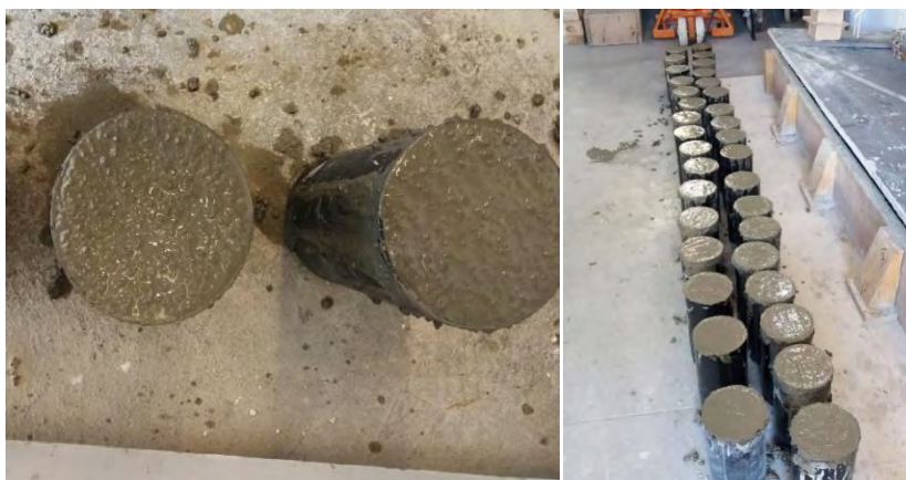
Σχήμα 2.7: Νωπό σκυρόδεμα στα καλούπια
