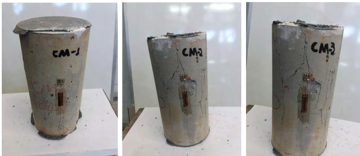
Σχήμα 3.2: Μορφές αστοχίας των κυλίνδρων CM μετά τη δοκιμή.
