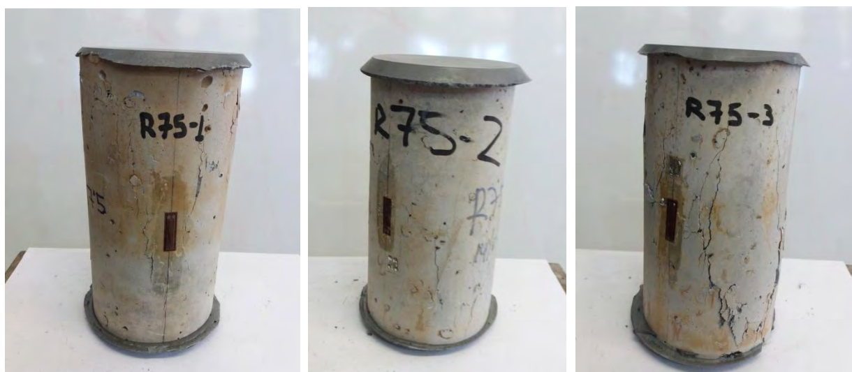
Σχήμα 3.8: Μορφές αστοχίας των κυλίνδρων R75 μετά τη δοκιμή.
