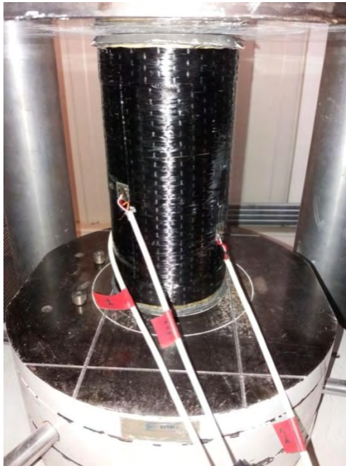
Σχήμα 3.1: Δοκίμιο με ενίσχυση GFRP κατά τη δοκιμή θλίψης
