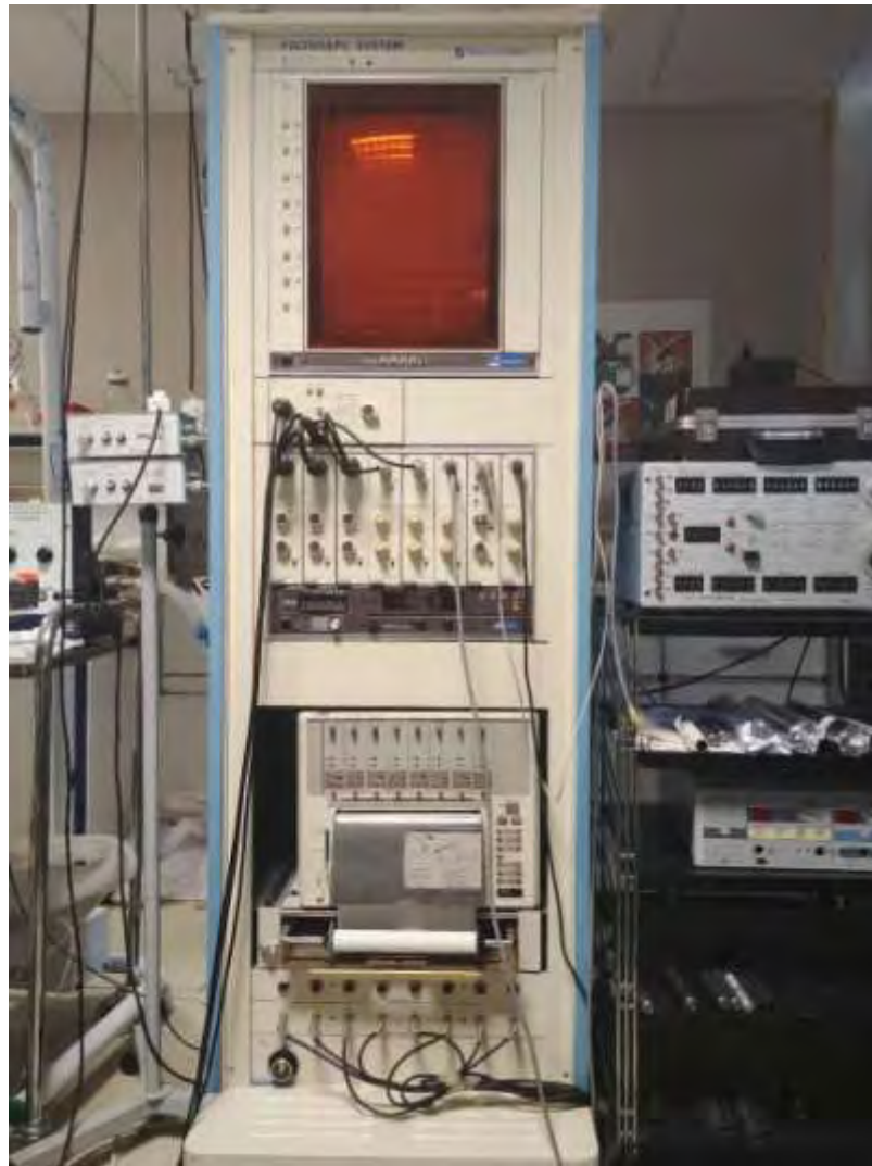
Εικόνα 14. Πολυκαταγραφικό σύστημα ηλεκτροκαρδιογραφικών απαγωγών, Nihon Kohden RM-600 polygraph amplifier system
