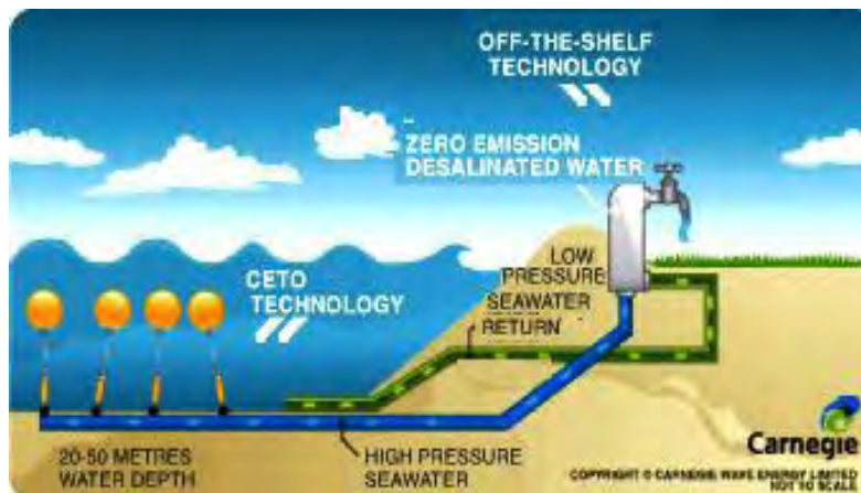
Σχήμα 15. Διάταξη αφαλάτωσης με κυματική ενέργεια
