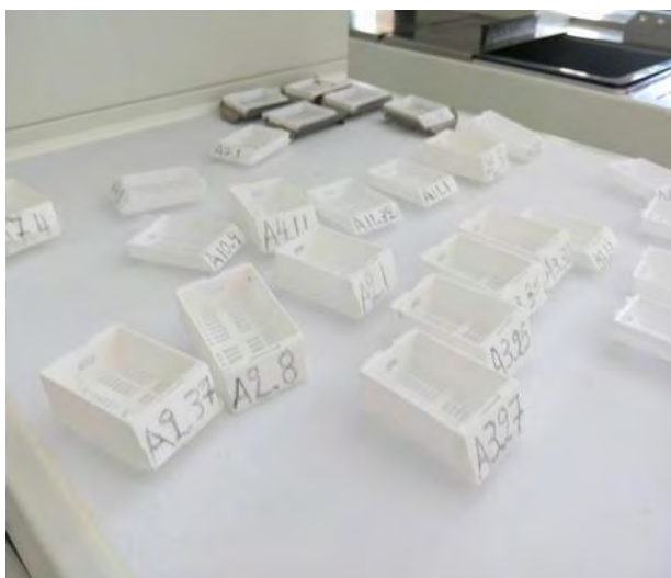
Εικόνα 2.4 : Κασετίνες γεμισμένες με υγρή παραφίνη, πάνω σε ψυχρή πλάκα για στερεοποίηση παραφίνης
