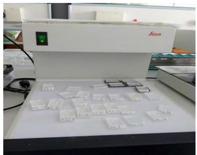
Εικόνα 2.4 : Κασετίνες γεμισμένες με υγρή παραφίνη, πάνω σε ψυχρή πλάκα για στερεοποίηση παραφίνης
