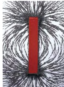
Εικόνα 5: Η μορφή του μαγνητικού πεδίου γύρω από έναν ραβδόμορφο μαγνήτη.
