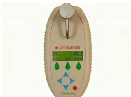
Εικόνα 7 Φορητός μετρητής χλωροφύλλης CCM-200 plus της OPTI-SCIENCE (πηγή: www.optisci.com )
