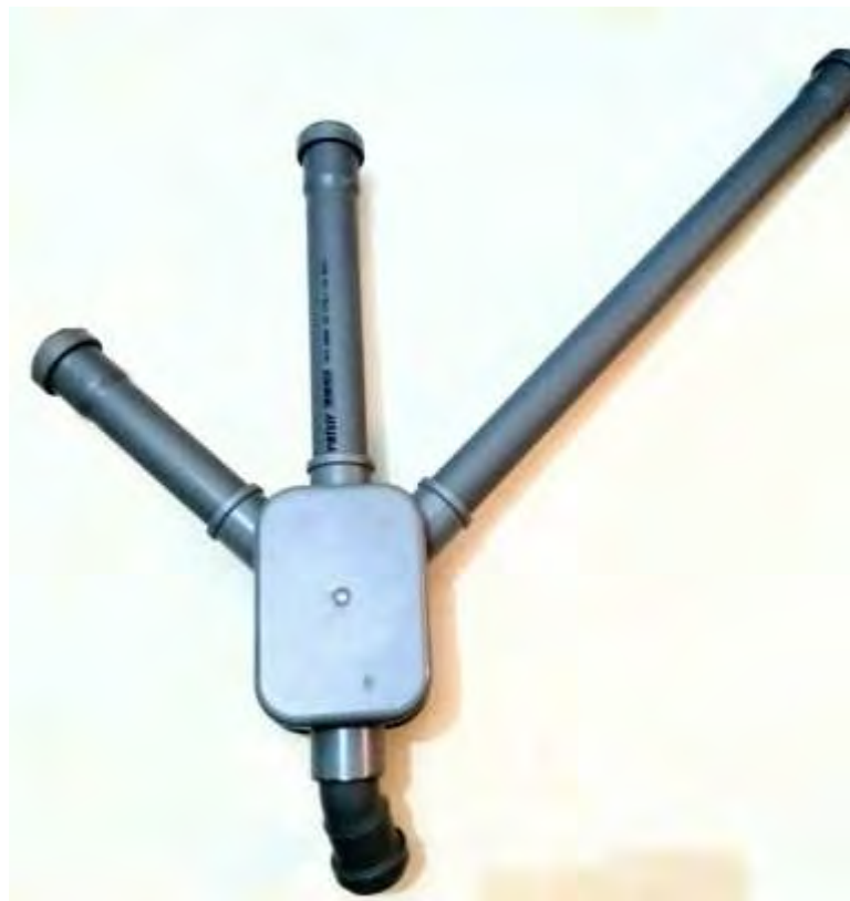
Εικόνα 36: Κατασκευή πνευστού από σωλήνες PVC.
