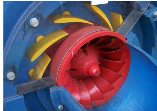
Εικόνα 5.10 Ανοικτή θέση ρυθμιστικών πτερυγίων [61]
