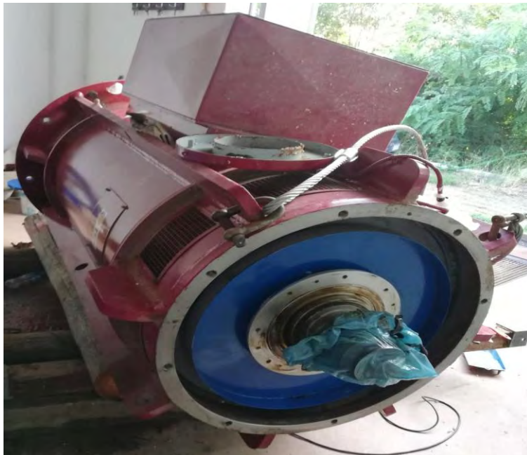
Εικόνα 7.10 Απεγκατάσταση άξονα από στρόβιλο για συντήρηση
