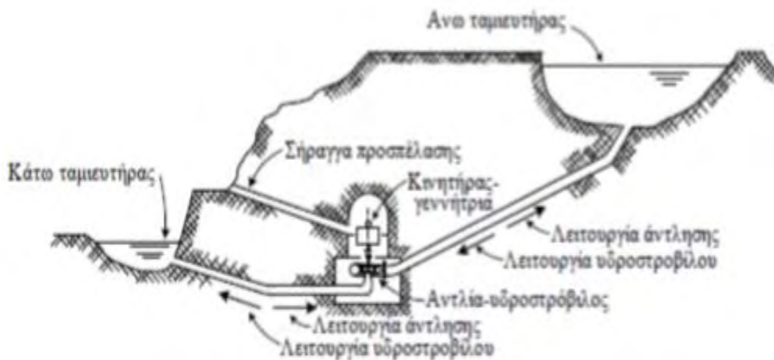
Εικόνα 3.7 Λειτουργία υδροηλεκτρικού σταθμού αντλησιοταμίευσης [23]
