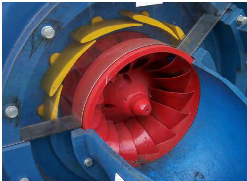
Εικόνα 5.9 Κλειστή θέση ρυθμιστικών πτερυγίων [61]
