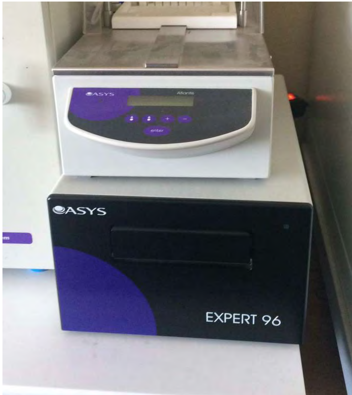
Εικόνα 15: Φωτόμετρο ELISA READER ASYS high - tech 656
