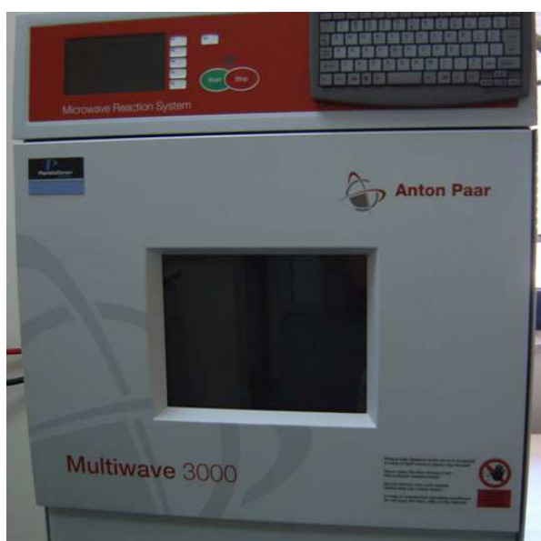
Εικόνα 2.4: Το σύστημα υγρής χώνευσης στις εγκαταστάσεις του Τμήματος.
