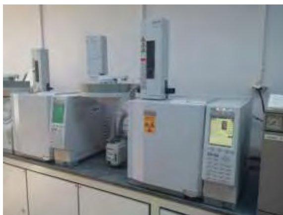
Εικόνα 10. Απεικόνιση αέριου χρωματογράφου Shimadzu GC -2010 Plus με ανιχνευτή ιονισμού φλόγας FID
