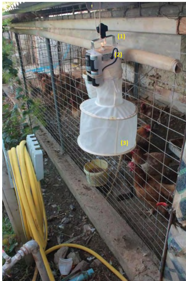
Εικόνα 33: Παγίδα τύπου CDC light trap πλησίον ορνιθώνα με αριθμημένα τα διάφορα τμήματά της. (1) Λαμπτήρας, (2) ανεμιστήρας, (3) πυθμένας παγίδας (Photo by: Tsirigotakis Nikolaos)
