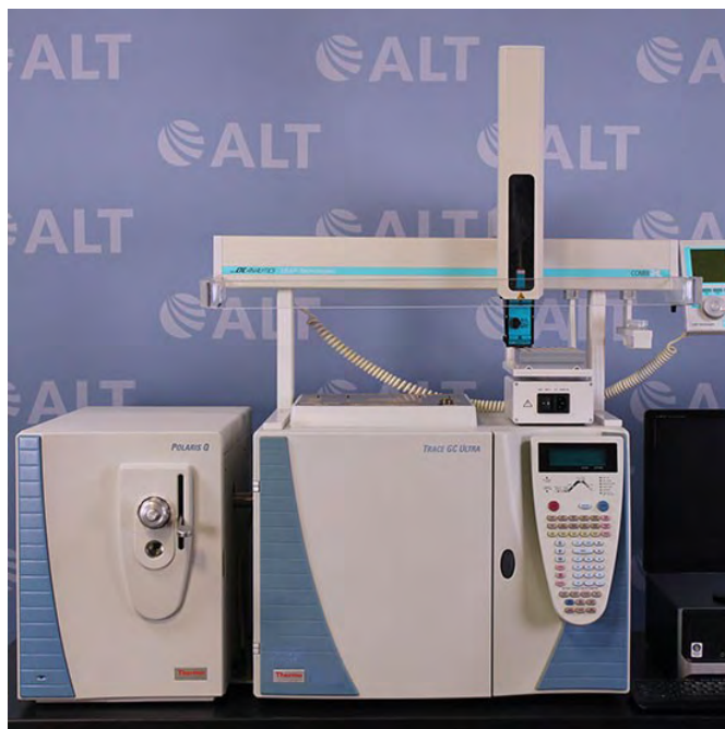
Εικόνα 3.4.1: Σύστημα Thermo Electron Corporation Ultra PolarisQ GC/MS Ion Trap Mass Spectrometer , παρόμοιο με αυτό που χρησιμοποιήθηκε στην παρούσα εργασία. (Ανακτήθηκε στις 12/12/2018 από https://americanlaboratorytrading.com/lab-equipment-products/thermo-electron-corporation-ultra-polarisq-gcms-ion-trap-mass-spectrometer-system_10833 )
