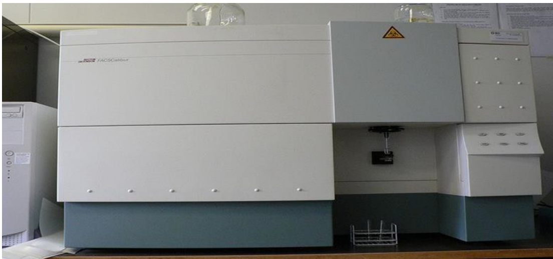
Εικόνα 20: Το μηχάνημα της κυτταρομετρίας ροής από την Becton-Dickinson.
