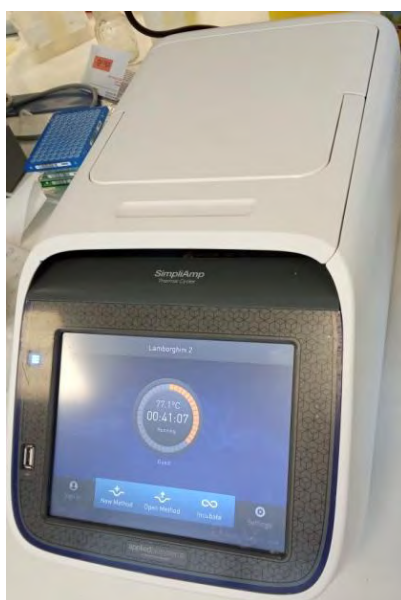
Εικόνα 13: Θερμοκυκλοποιητής SimpliAmp της, Appliedbiosystems που χρησιμοποιήθηκε στις PCR.
