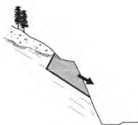
Εικόνα 3-2. Σκαριφηματική τομή πρανούς σε επίπεδη αστοχία [4]
