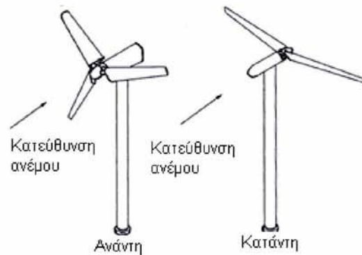
Σχήμα 2.30 Τύποι ανεμογεννητριών οριζόντιου άξονα
