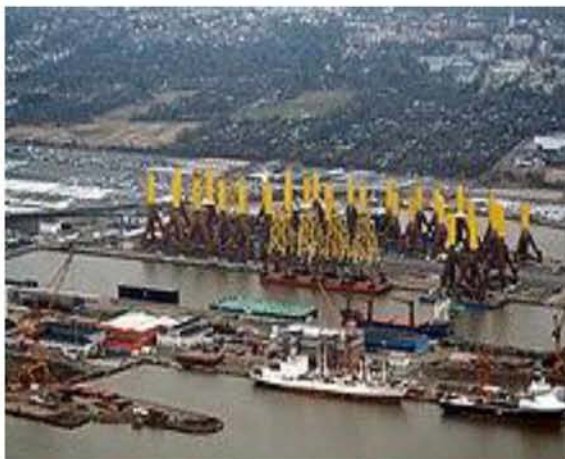
Εικόνα 5 : α) Κατασκευές διαφόρων τύπων θεμελίωσης για υπεράκτιες ανεμογεννήτριες σε ένα λιμάνι, (β) Κατασκευές θεμελίωσης τύπου Tripod για υπεράκτιο αιολικό πάρκο το 2008 στο Wilhelmshaven, Γερμανία. (Πηγή:
