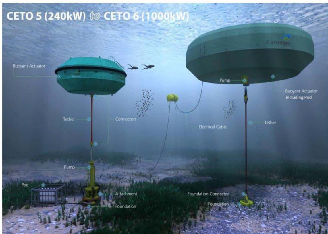
Εικόνα 33: Συσκευές Ceto 5 & Ceto 6. (Πηγή: https://www.carnegiece.com/wave/what-is-ceto/ )
