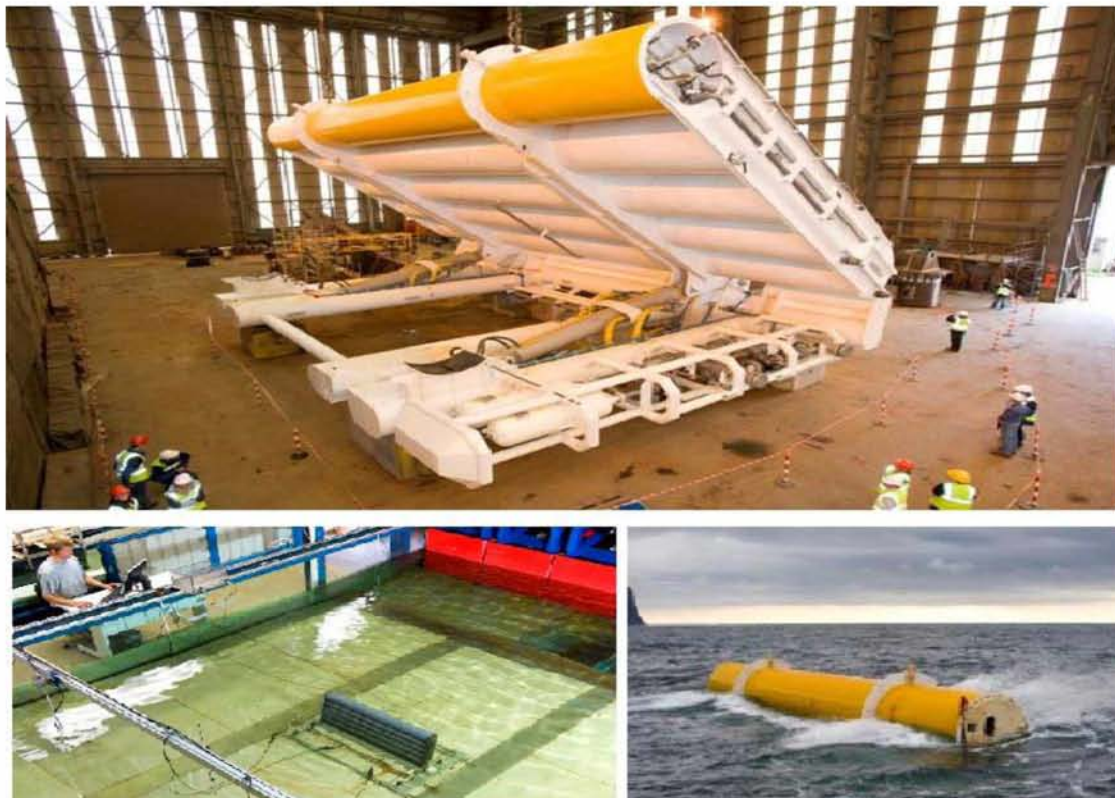
Εικόνα 28: Συσσκευή οριζόντιας κυματικής παλινδρόμησης Oyster. (Πηγή: www.aquamarinepower.com )
