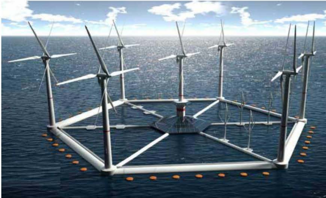
Εικόνα 6: Πρόταση πλωτού συστήματος ανεμογεννητριών σε εξαγωνική βάση. (Πηγή: https://ecofriend.com/hexicon-s-hexagonal-floating-wind-platform-could-reduce-maintenance-costs.html )
