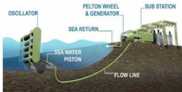
Σχήμα 9: Σχηματικό διάγραμμα του συστήματος Oyster. (Πηγή: www.aquamarinepower.com )
