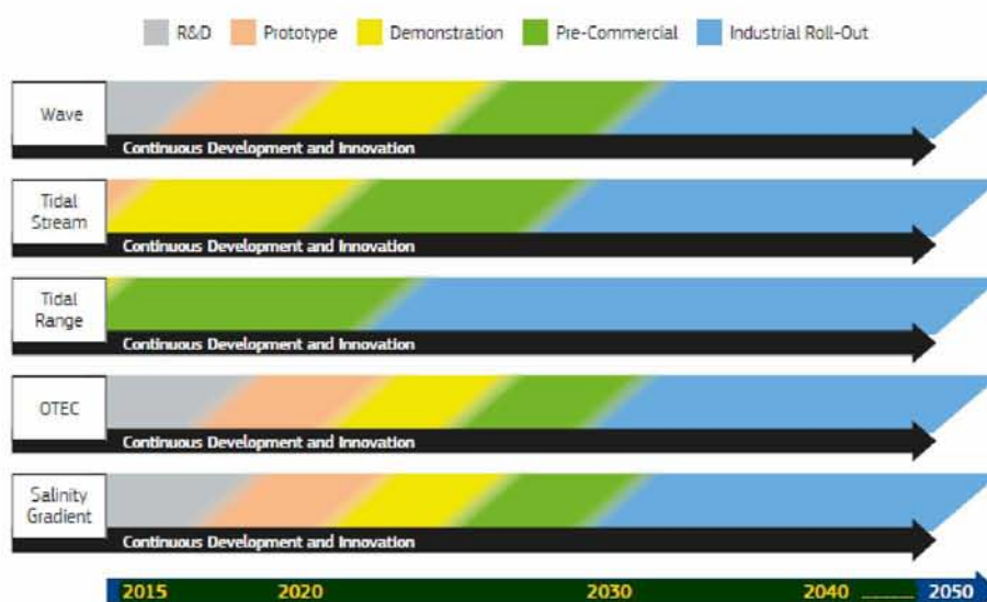
Σχήμα 12: Εκτίμηση χρονοδιαγράμματος της ανάπτυξης σε φάσεις για τις τεχνολογίες ωκεάνιας ενέργειας. (Πηγή: Ocean Energy Forum)
