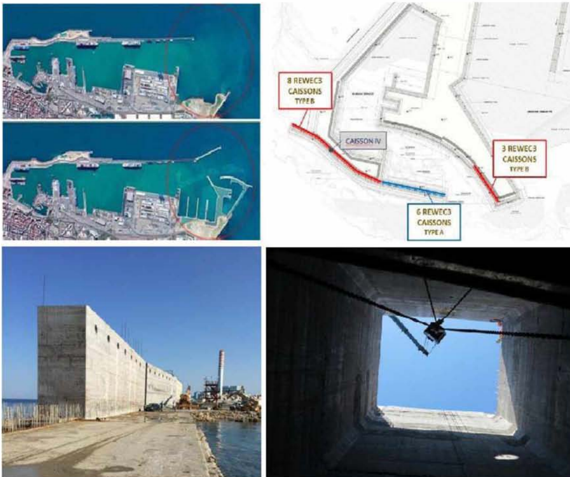
Εικόνα 24: Η θέση των συσκευών REWEC3 στους κυματοθραύστες που προστατεύουν τις νέες αποβάθρες (κόκκινοι κύκλοι). (Πηγή: Arena F. et al, 2017).
