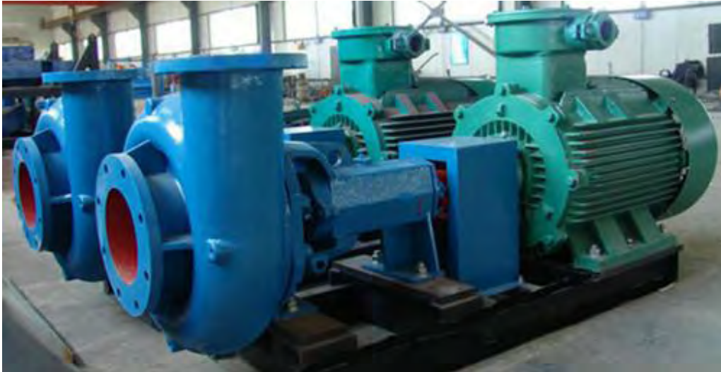
Εικόνα 6-4: Τυπικές φυγόκεντρες αντλίες διυλιστηρίων [59].
