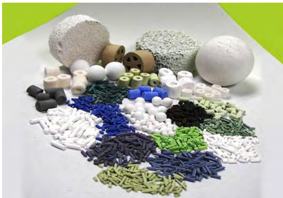
Εικόνα 6-1: Τυπικοί καταλύτες υδρογονοαποθείωσης [46].
