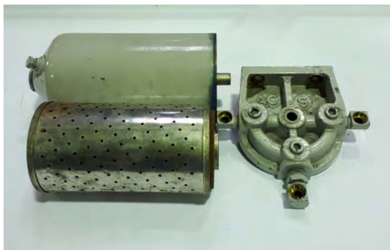
Εικόνα 2.21 Φίλτρο καυσίμου (Εργαστήριο Π.Θ.)
