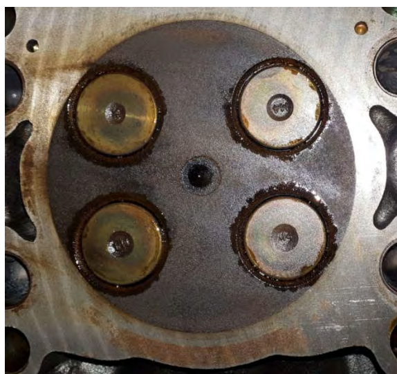
Εικόνα 2.7 Βαλβίδες εξαγωγής (Εργαστήριο Π.Θ.)
