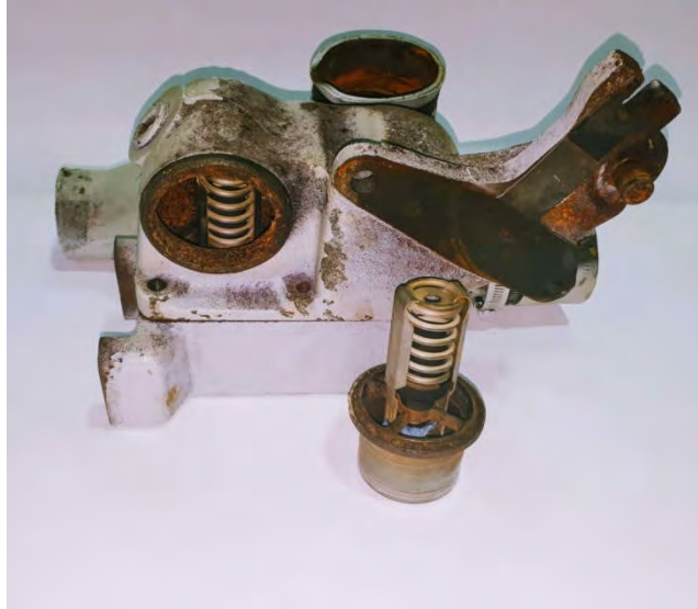
Εικόνα 2.15 Θερμοστάτης (Εργαστήριο Π.Θ.)
