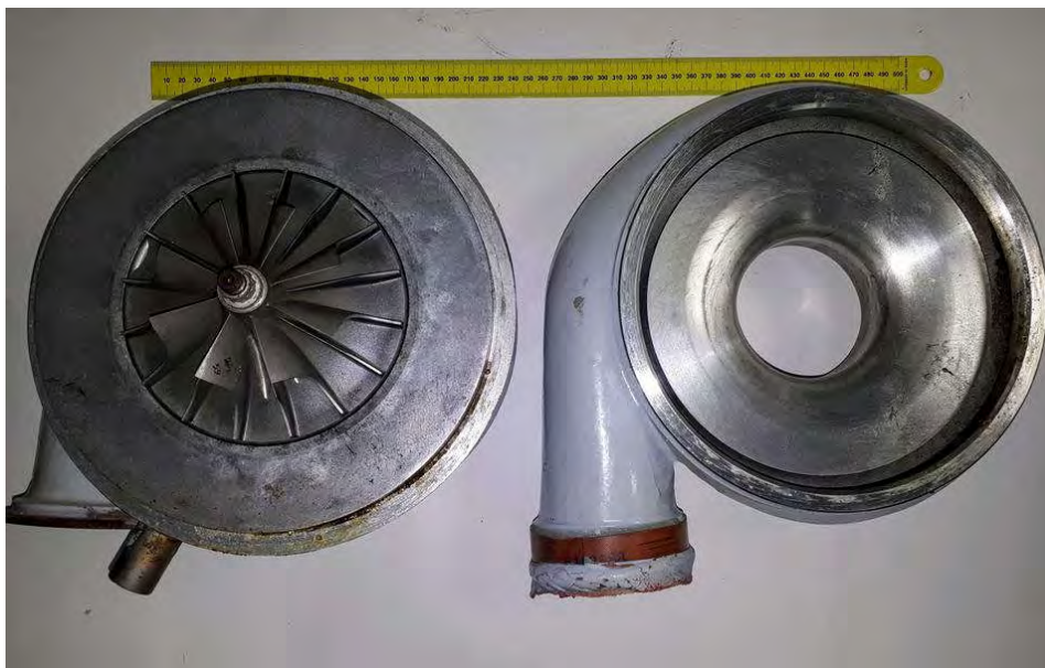
Εικόνα 2.27 Εσωτερικό στροβιλοσυμπιεστή (Φτερωτή)
