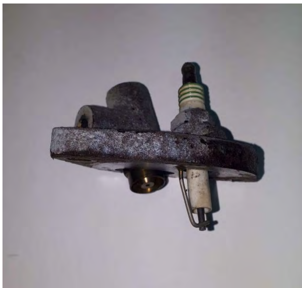
Εικόνα 2.28 Προθερμαντήρας (Εργαστήριο Π.Θ.)
