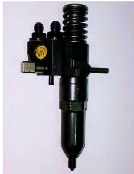
Εικόνα 2.19 Εγχυτήρας καυσίμου (Εργαστήριο Π.Θ.)
