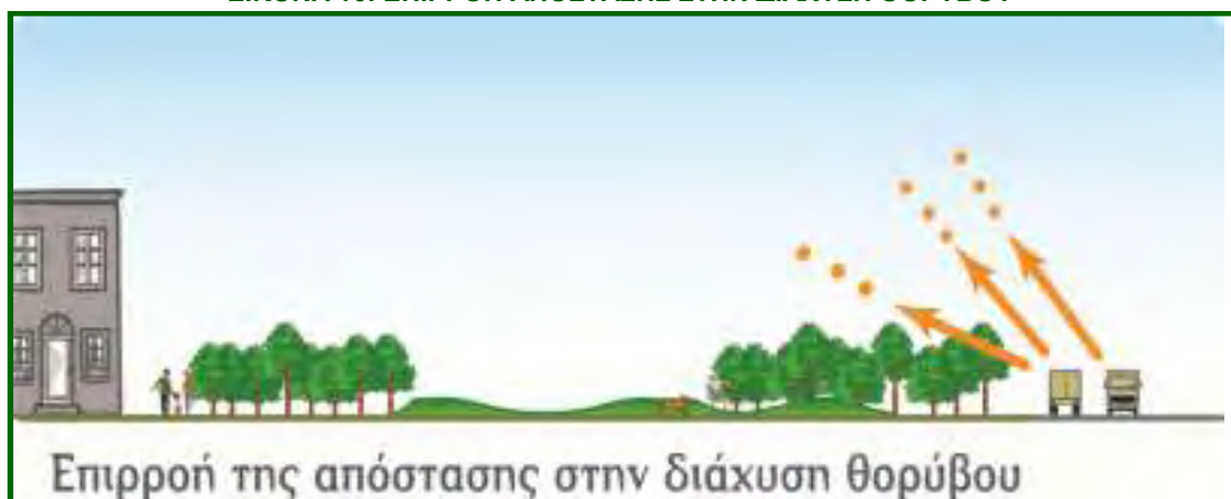
ΕΙΚΟΝΑ 16: ΕΠΙΡΡΟΗ ΑΠΟΣΤΑΣΗΣ ΣΤΗΝ ΔΙΑΧΥΣΗ ΘΟΡΥΒΟΥ
