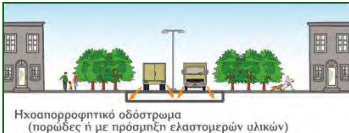
ΕΙΚΟΝΑ 14: ΗΧΟΑΠΟΡΡΟΦΗΤΙΚΟ ΟΔΟΣΤΡΩΜΑ
