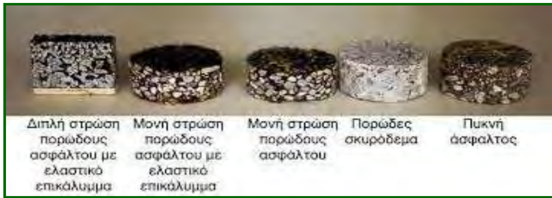
ΕΙΚΟΝΑ 15: ΤΥΠΟΙ ΟΔΟΣΤΡΩΜΑΤΩΝ
