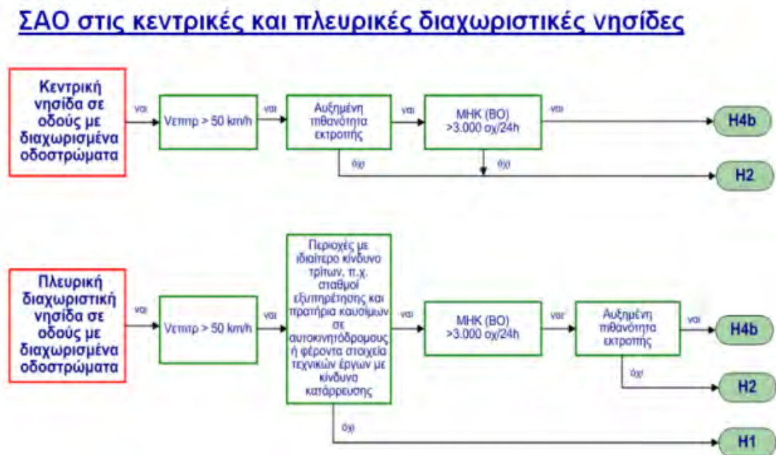
Διάγραμμα 5 : Κριτήρια εφαρμογής στηθαίων ασφαλείας σε κεντρικές και πλευρικές διαχωριστικές νησίδες Πηγή : (ΥΠ.Υ.ΜΕ.ΔΙ. - Γ.Γ.Δ.Ε., 2010)).
