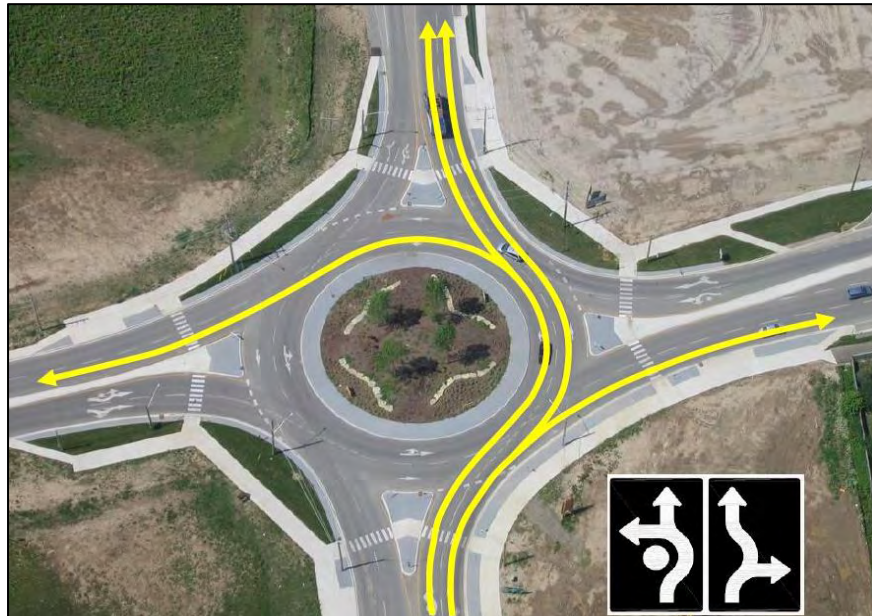
Εικόνα 3.7 Τρόπος κίνησης οχημάτων σε K^3 δύο λωρίδων [27]
