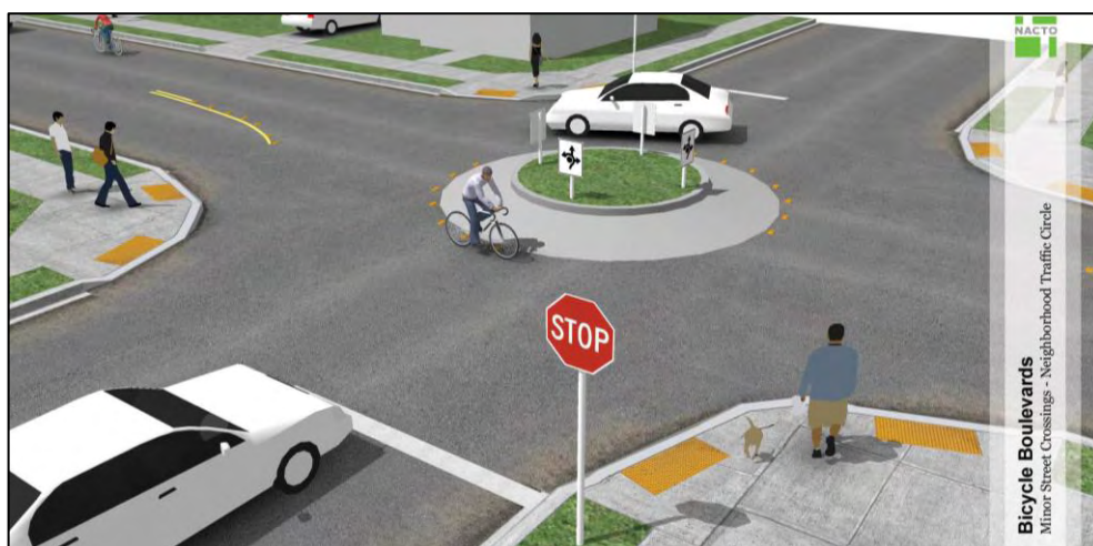
Εικόνα 3.4 Τρισδιάστατη απεικόνιση κυκλοφοριακού κύκλου γειτονιάς [23]
