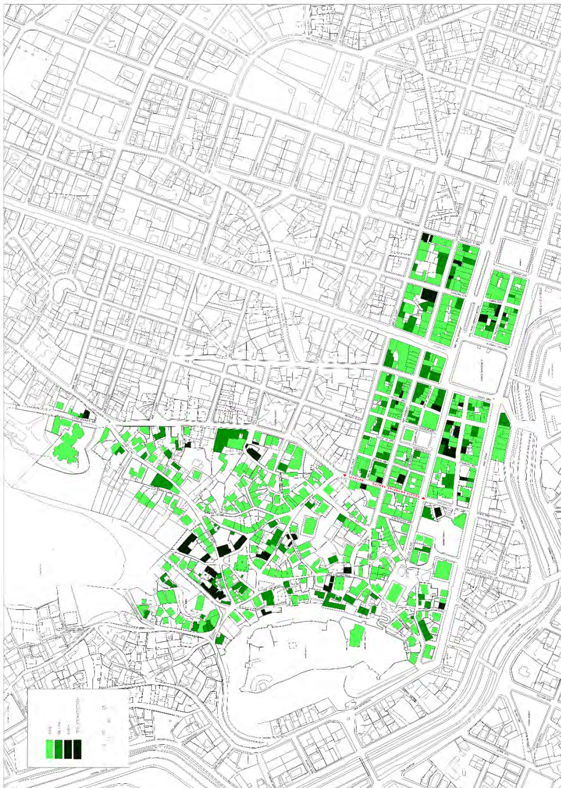
Χάρτης 9: Φυσική Κατάσταση των Κτηρίων, στο Βαρύσι και το Παλαιό Εμπορικό Κέντρο των Τρικάλων. Ίδια Επεξεργασία.
