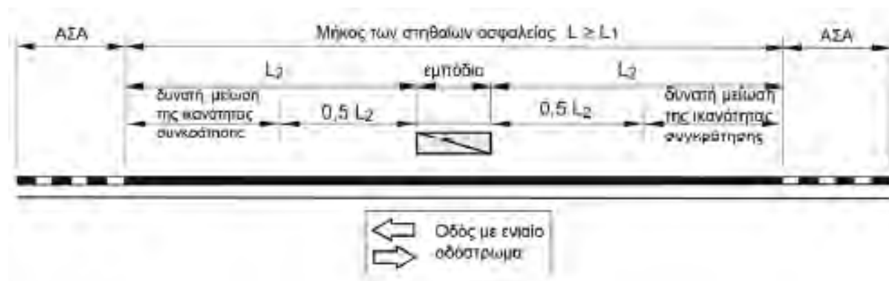
Σχήμα 2.7-1: Μήκη στηθαίων ασφαλείας για οδούς ενιαίου οδοστρώματος. [13]
