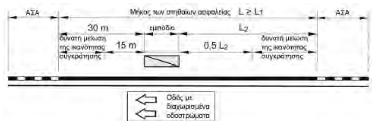
Σχήμα 2.7-2: Μήκη στηθαίων ασφαλείας για οδούς με διαχωρισμένα οδοστρώματα. [13]
