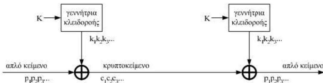
Εικόνα: Αρχή λειτουργίας κρυπταλγόριθμου ροής
