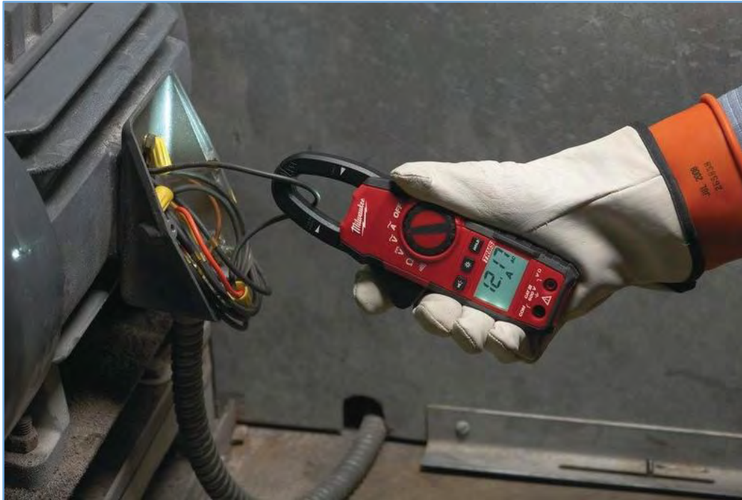
Σχήμα 3: Μέτρηση έντασης ρεύματος με χρήση αμπεροτσιμπίδας.
