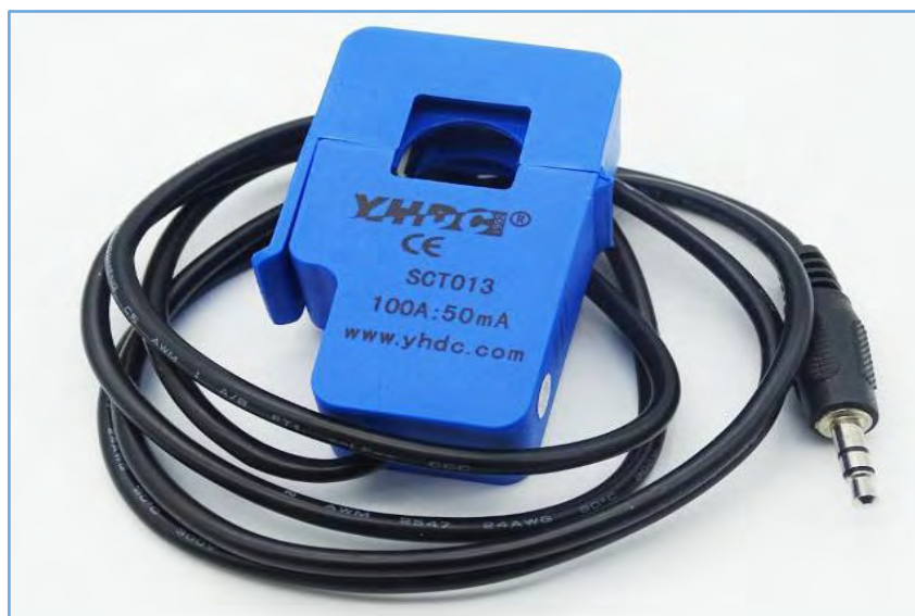
Σχήμα 14: Μετρητής ρεύματος SCT-013 100A.
