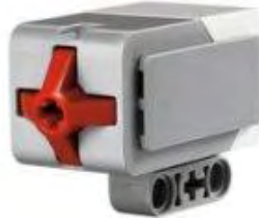
Εικόνα 3.7: Ο αισθητήρας αφής Touch Sensor
