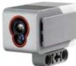
Εικόνα 3.6: Ο αισθητήρας χρώματος Color Sensor
