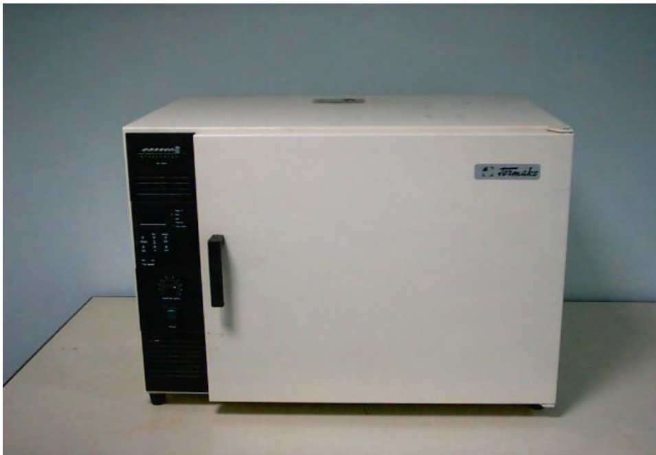
Εικόνα 2.7: Εργαστηριακός φούρνος Termaks για την ξήρανση των δειγμάτων εδάφους
