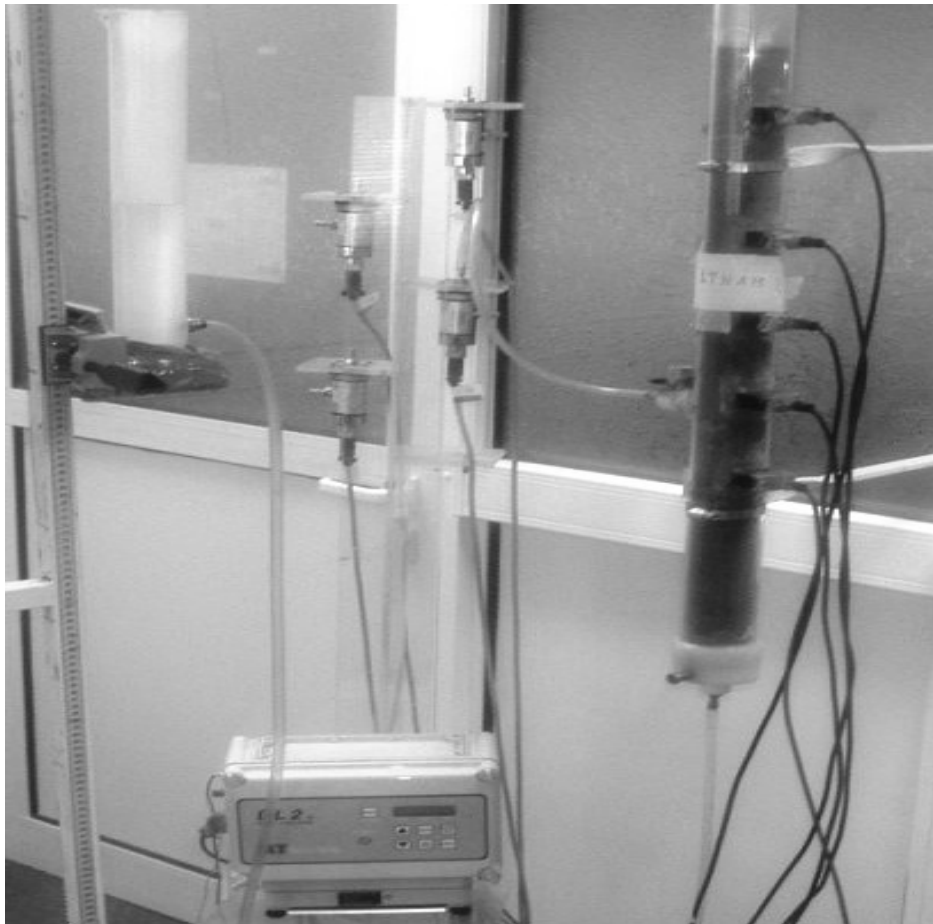
Εικόνα 2.6: Διάταξη μέτρησης της πίεσης. Η κεραμική κάψα της πειραματικής στήλης συνδέεται με εύκαμπτο σωλήνα με τον μετατροπέα πίεσης, ο οποίος με τη σειρά του συνδέεται με το καταγραφικό (data logger)
