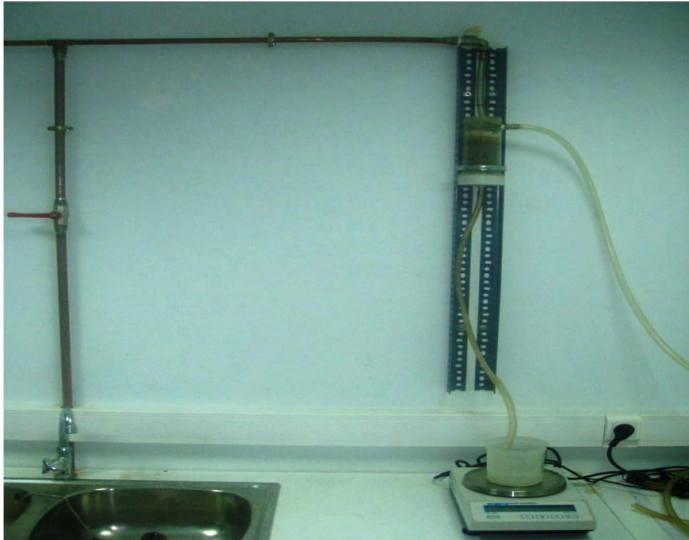
Εικόνα 3.1: Διάταξη που χρησιμοποιήθηκε για τη μέτρηση της υδραυλικής αγωγιμότητας κορεσμού με τη μέθοδο σταθερού φορτίου
