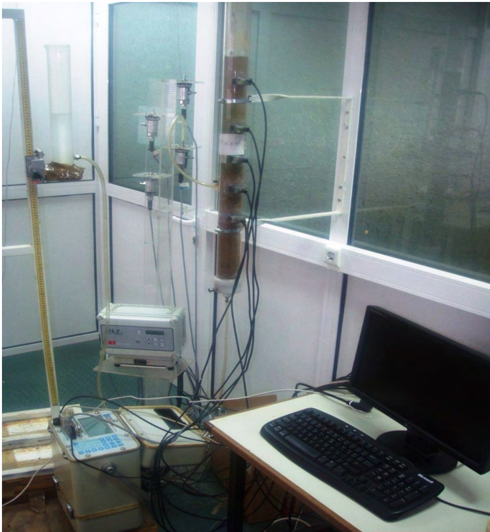
Εικόνα 3.3: Πειραματική διάταξη για τη μελέτη των χαρακτηριστικών καμπυλών του εδάφους.
