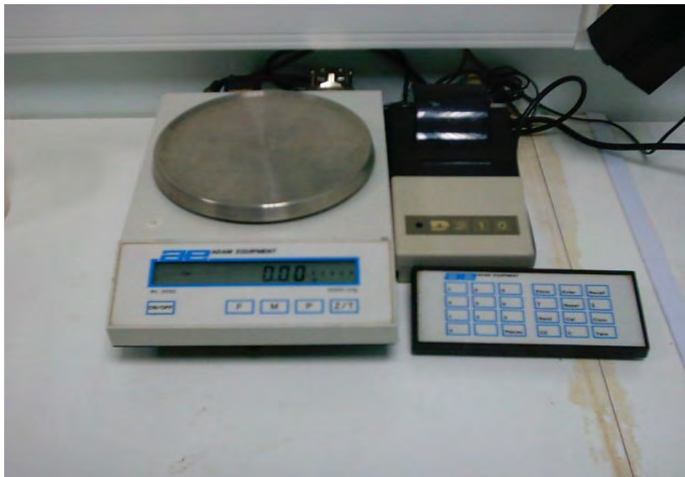
Εικόνα 2.9: Ψηφιακός ζυγός Adam Equipment, ακρίβειας 2 δεκαδικών ψηφίων για τη ζύγιση των εδαφικών δειγμάτων.
