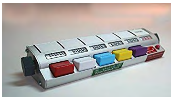
Εικόνα: Μετρητής χειροκίνητος εργαστηρίου (totalizer laboratory denominator). Κάθε πλήκτρο αντιστοιχεί σε ένα είδος κίνησης και στο τέλος υπολογίζεται το ποσοστό της κάθε κίνησης επί τοις εκατό.
