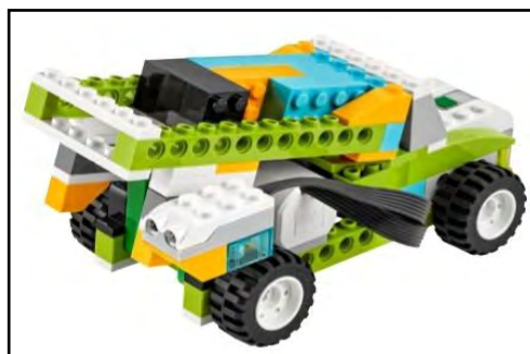
Εικόνα 19. Προσθήκη αισθητήρα στην κατασκευή
