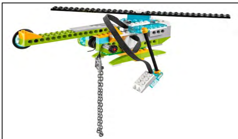
Εικόνα 16. Ενδεικτική κατασκευή με χρήση αισθητήρα απόστασης
