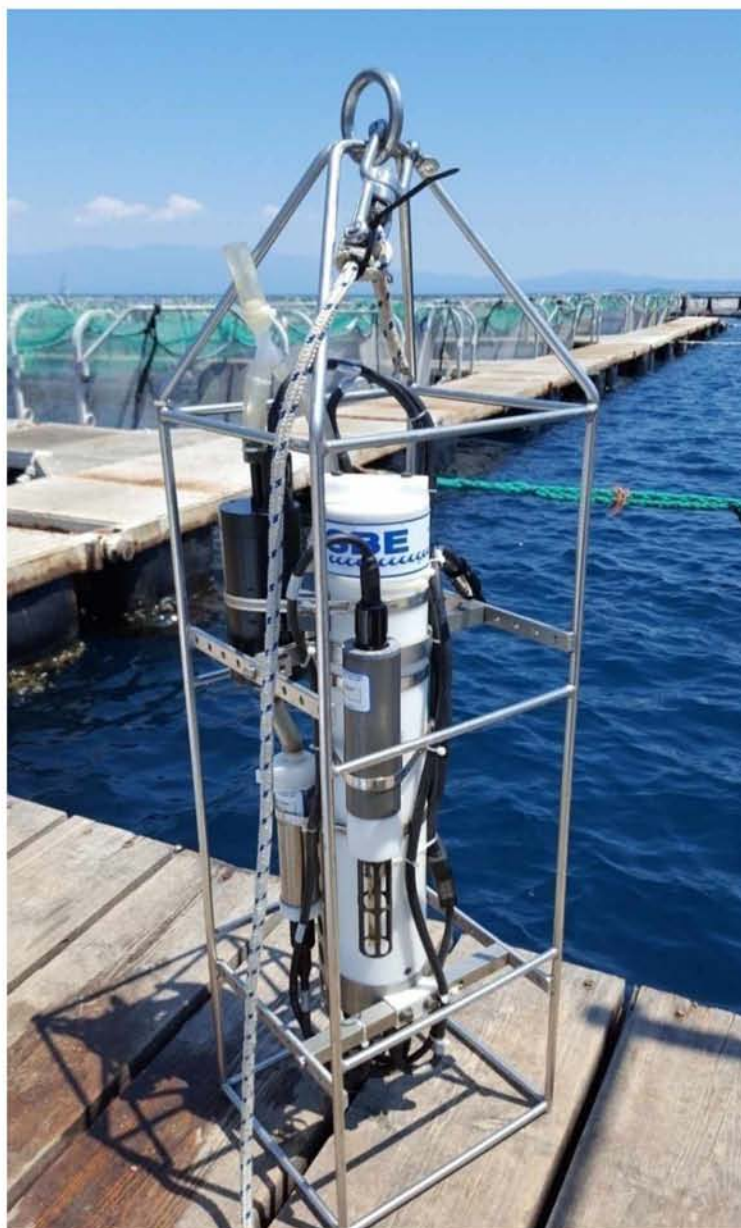
Εικόνα 2.4: Αυτογραφικό όργανο καταγραφής φυσικοχημικών χαρακτηριστικών του νερού της εταιρείας Sea Bird Electronics.
