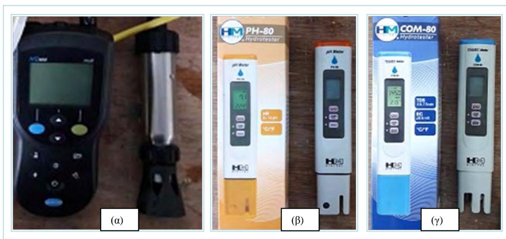
Εικόνα 12: Όργανα μέτρησης παραμέτρων νερού (α) Ψηφιακό οξυγονόμετρο, (β) Ψηφιακό όργανο μέτρησης pH, (γ) Ψηφιακό όργανο μέτρησης ηλεκτρικής αγωγιμότητας (Προσωπικό αρχείο)
