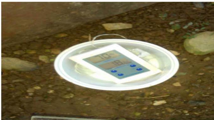
Εικόνα 7. Το όργανο μέτρησης ημερήσιας υγρασίας και θερμοκρασίας με το πλαστικό μπολάκι που τοποθετήθηκε. (Πηγή: προσωπικό αρχείο)
