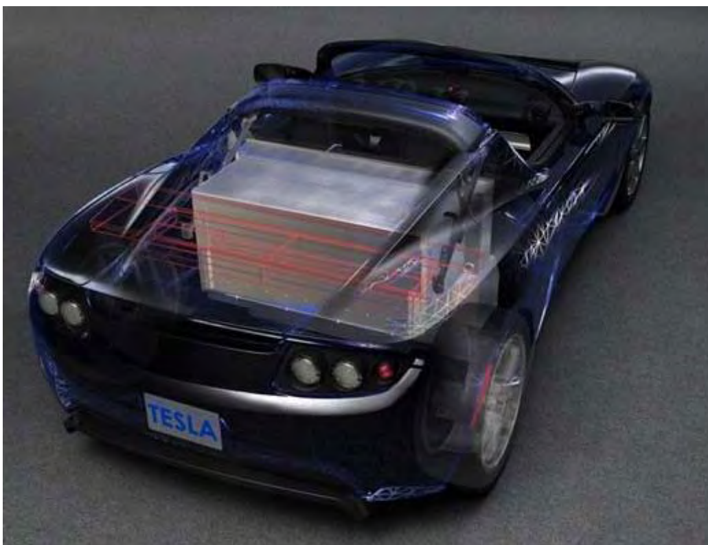
Σχήμα 4.3 - Η μπαταρία του Roadster [99]
