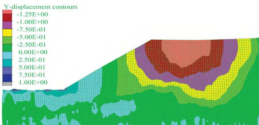
Σχήμα 7.43: Μόνιμη κατακόρυφη μετατόπιση μετά το τέλος της σεισμικής δόνησης.
